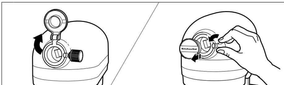
**Pour les batteurs sur socle dont la prise à accessoires multifonction est équipée d'un couvercle à charnière :** Relever le couvercle pour ouvrir.
